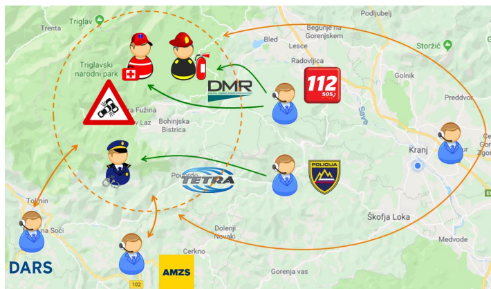
Prikaz zmožnosti komunikacije med omrežji TETRA in DMR s posredovanjem dispečerja v klicnem centru
